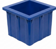
Beton Numune Kalıpları
