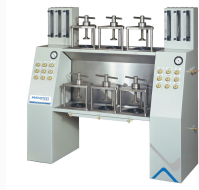
Beton Permeabilite (Gecirimsizlik) Denev Cihaz
