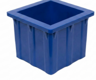
Beton Numune Kalıpları
